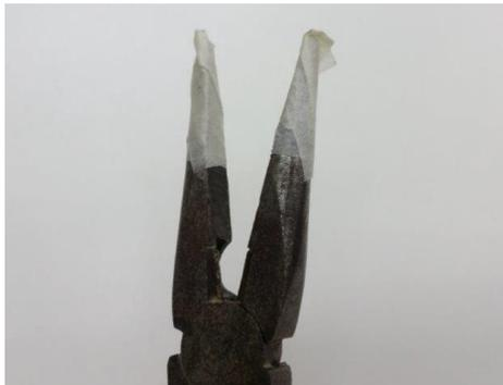
傷防止のために時計側とラジオペンチの間にウエスや薄紙を用意するか、ラジオペンチの先端に保護をする（養生テープなど）
