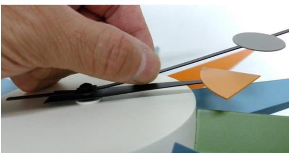
干渉している指針を手前（本体と反対側）に向けて手でゆっくり反らす（2 mm以上の隙間をつくる）
